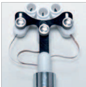
Sonda tewameter do pomiaru przesnaskórkowej utraty wody (TEWL).
