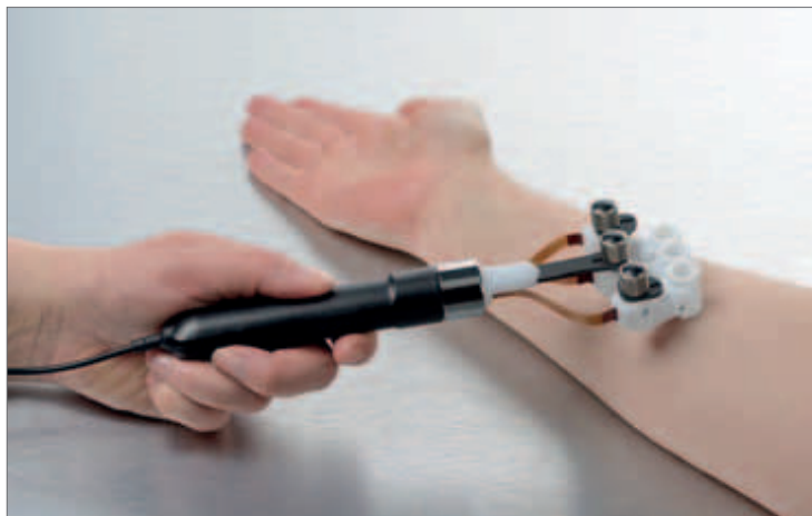
Pomiar przesnaskórkowej utraty wody sondą tewameter.
